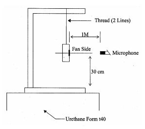
1 METER FROM MICROPHONE TO FAN INTAKE
